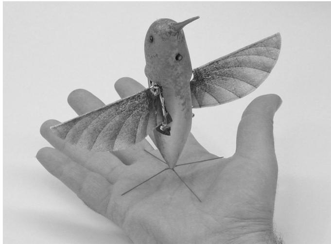
Figura 9 - Modelo de Nano Air Vehicle (NAV) - Nano Hummingbird.
