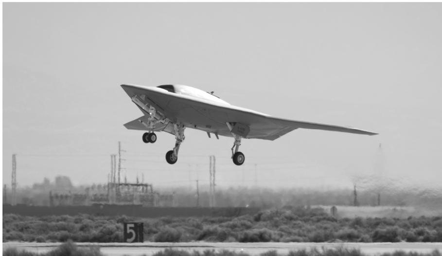
Figura 11 - Modelo de um VANT de combate (UCAV) - X-47B.
