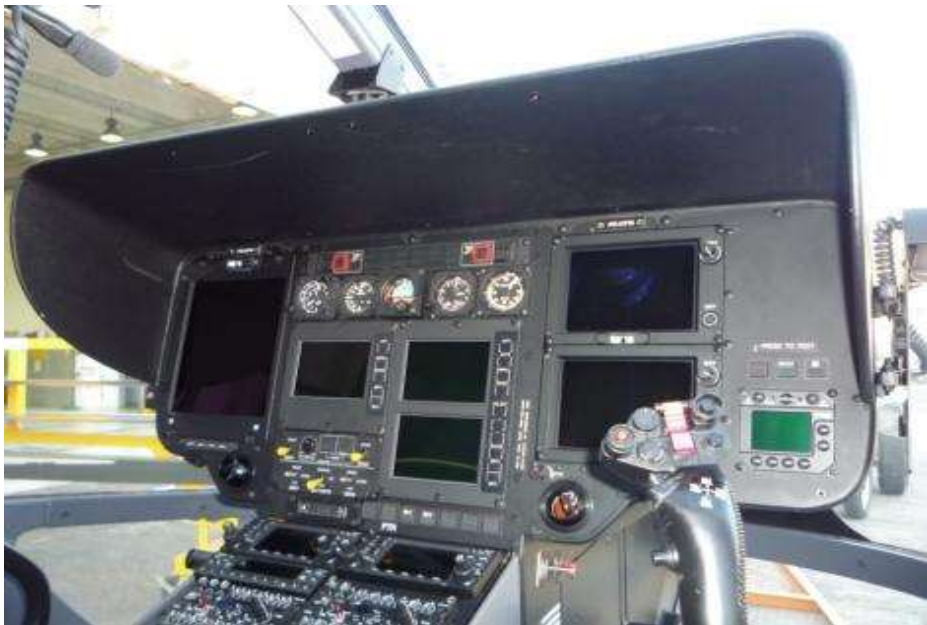
Painel do BK 117 C2 (EC 145) com VEMD e CAD e outros recursos
