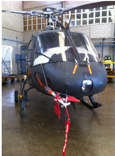
Figura 1 – Modelo AS 550 – EB 1023 com instrumentação de ensaio.
