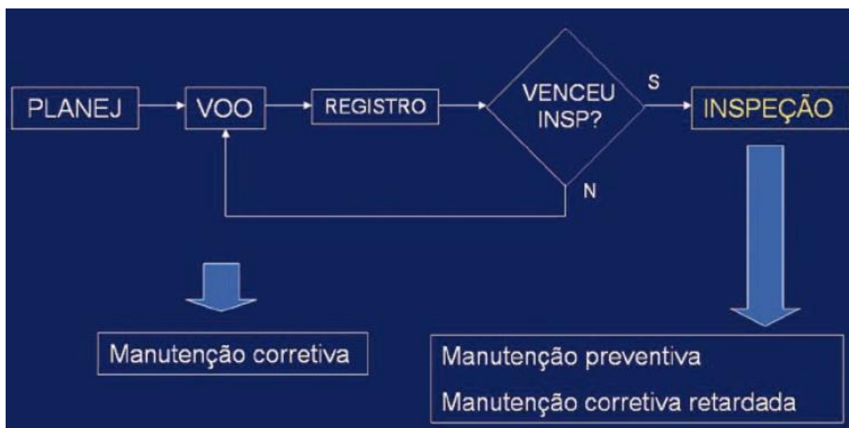
Figura 3 – Sequência Atividades de Manutenção
