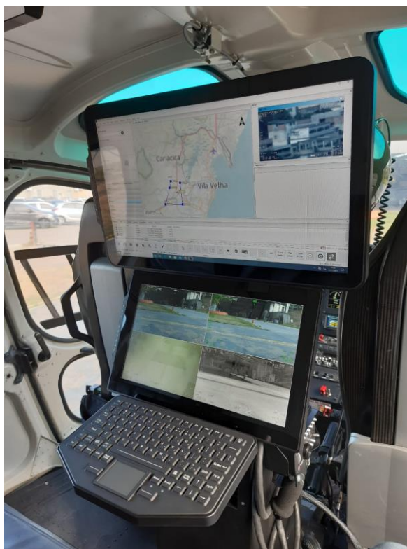
Figura H2 – Sistema de missão AIMS-HD instalado na cabine
