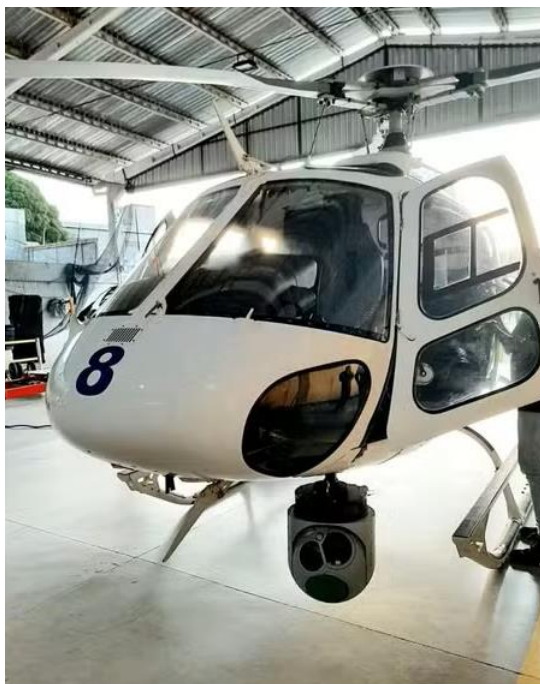
Figura H1 – Sistema de vigilância Wescam MX-15 acoplado à aeronave
